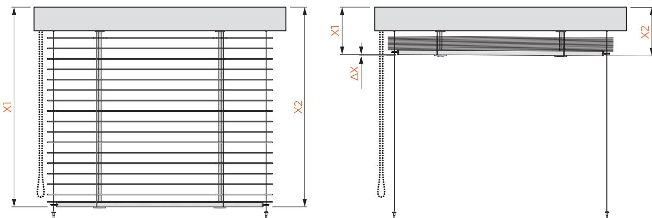
Maximální rozdíl výšek (měřeno v kraji žaluzie) je dán hodnotou 10 mm:  $\Delta X = | X_1 - X_2 | \leq 10 \text{ mm}$ .
