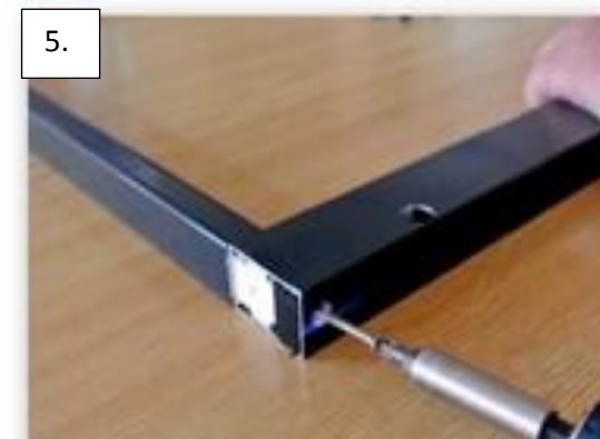
Zajišťovací profil zarovnejte s vodícími profily a zajistěte šrouby.
